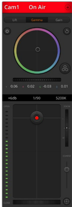
Mit ATEM Camera Control lassen sich Blackmagic Studio Cameras über Ihren ATEM Mischer steuern
