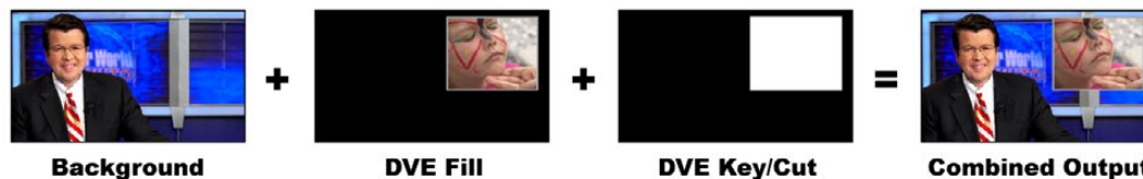
Совмещение фона, заполняющего и вырезающего сигналов при работе с видеоэффектами
