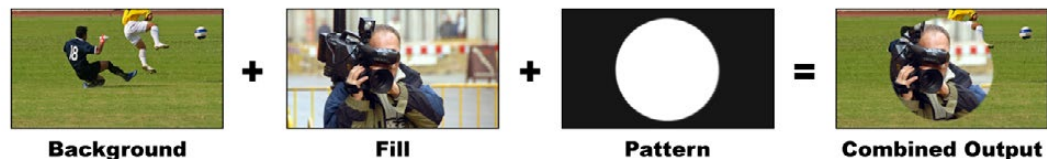
Объединение фона и заполняющего сигнала при шаблонном наложении
