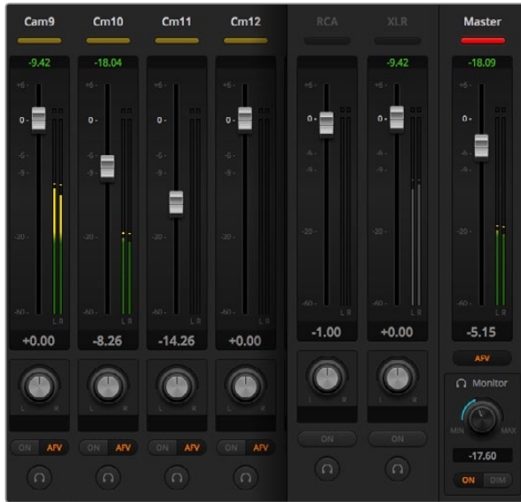
하드웨어 컨트롤 서페이스의 게인 페이더를 위/아래로 움직이면서 컴퓨터 화면의 소프트웨어의 오디오 믹서 페이더가 같이 움직이는 지를 확인하세요.
