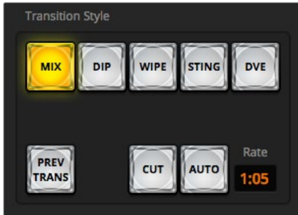
Die Übergangsschaltfläche „Auto“ gehört zur Tastengruppe für Übergangsarten
