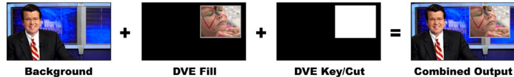
バックグラウンド、DVEフィル、DVEキー/カットの結合
