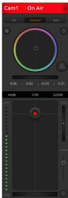
El módulo de control permite manejar una Studio Camera desde el ATEM.
