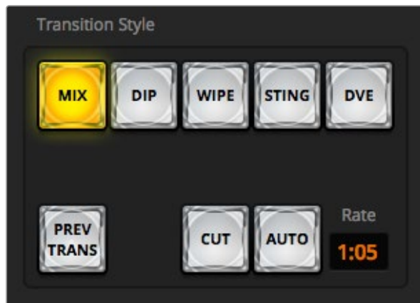
El botón "Auto" forma parte del módulo de transiciones.
